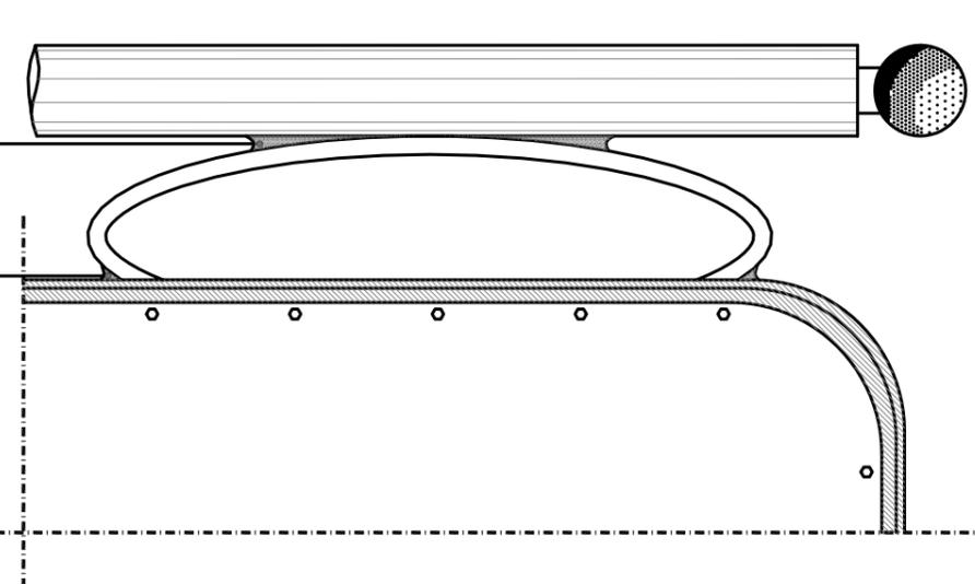
PARTICOLARE COSTRUTTIVO DELL'INNESTO TRA IL COLONNINO E IL PANNELLO scala 1:5
